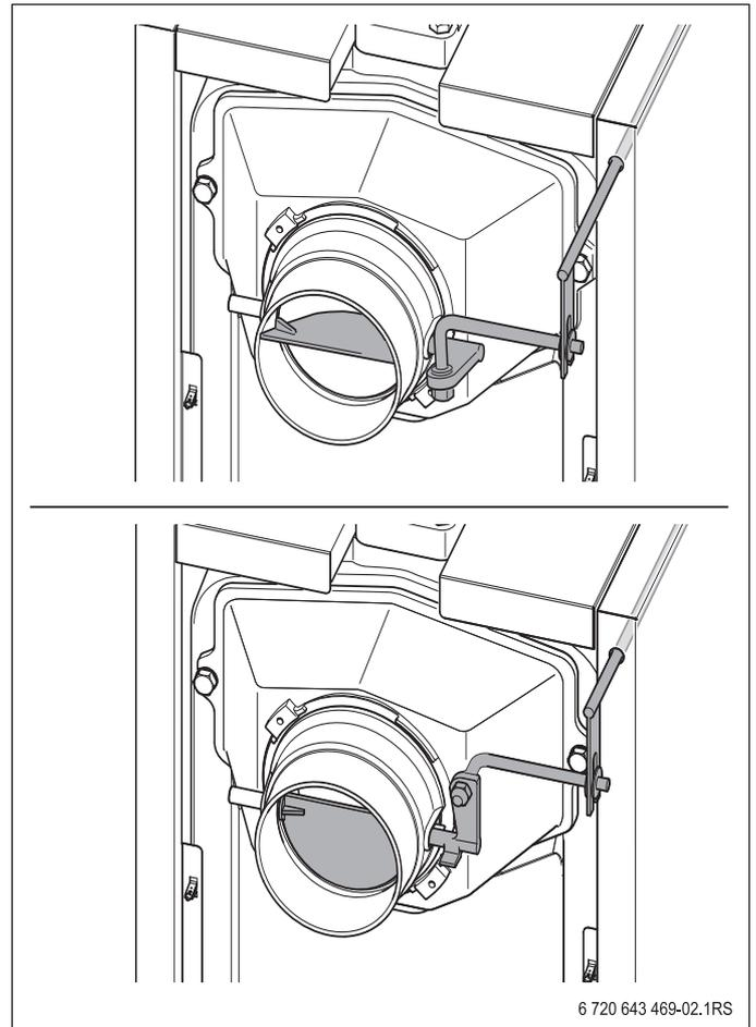
Рис. 2 Дымовая заслонка (вверху открыта; внизу закрыта)
