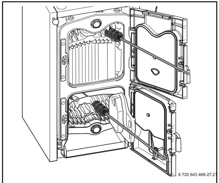
Рис. 10 Чистка газоотводящих каналов
