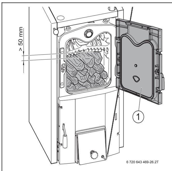
Рис. 9 Дозагрузка дров
