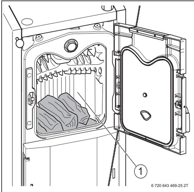
Рис. 7 Дозагрузка топлива
