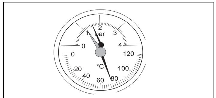
Рис. 3 Термоманометр
