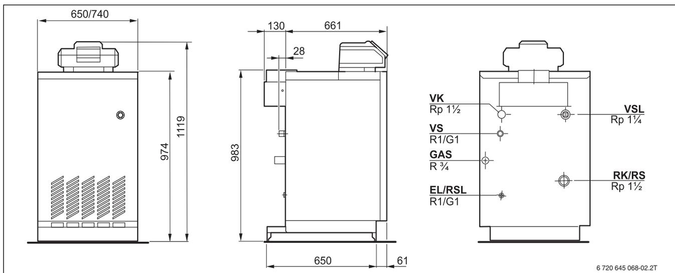
Рис. 4 Размеры и подключения (в мм)
