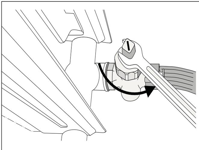
Рис. 11 Слив воды из отопительной системы при опасности заморзания
