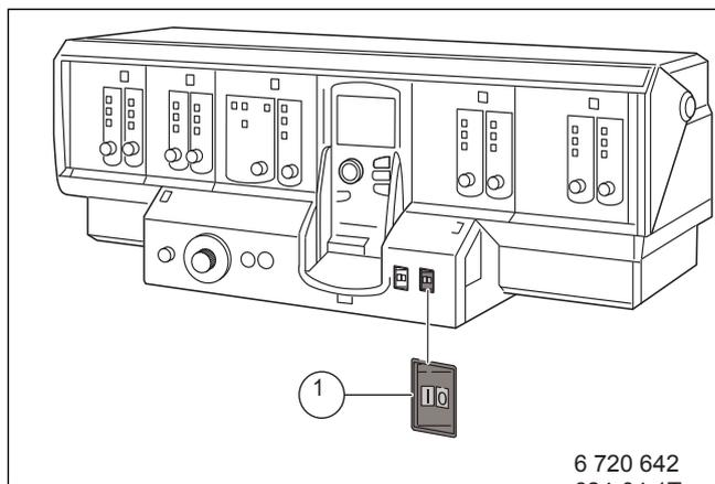
Рис. 10 Выключение отопительной установки (Logamatic 4000)[1] Пусковой выключатель
