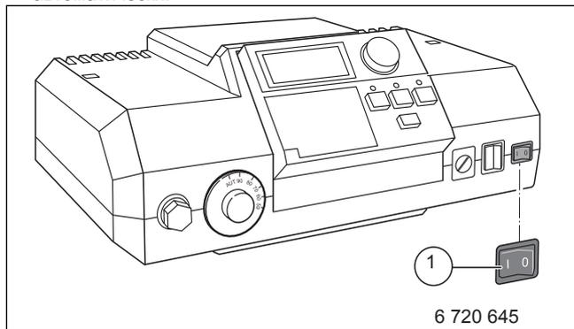
Рис. 9 Выключение отопительной установки (Logamatic 2000)[1] Пусковой выключатель
