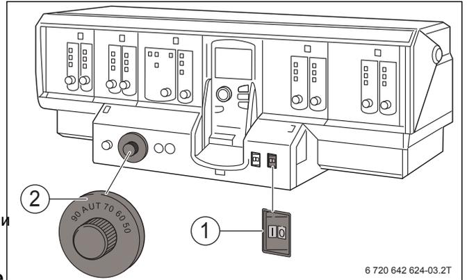
Рис. 6 Включите отопительную установку на системе управления (Logamatic 4000)
