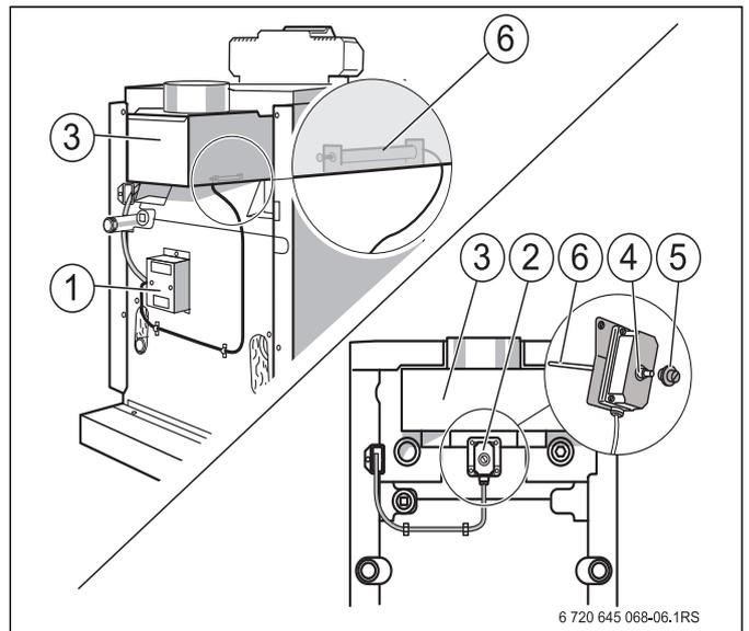
Рис. 2 Устройство контроля дымовых газов
