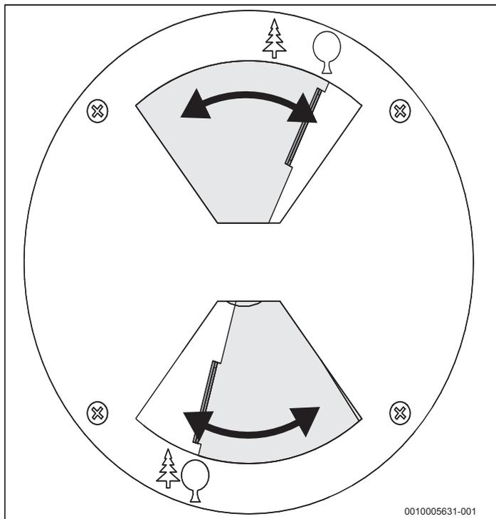
Рис. 3 Пример регулировки воздушных заслонок
