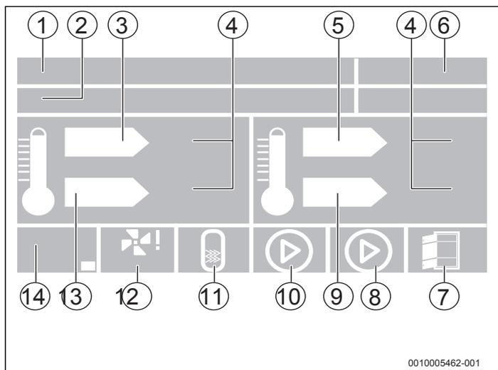
Рис. 7 Стандартная индикация параметров котла
