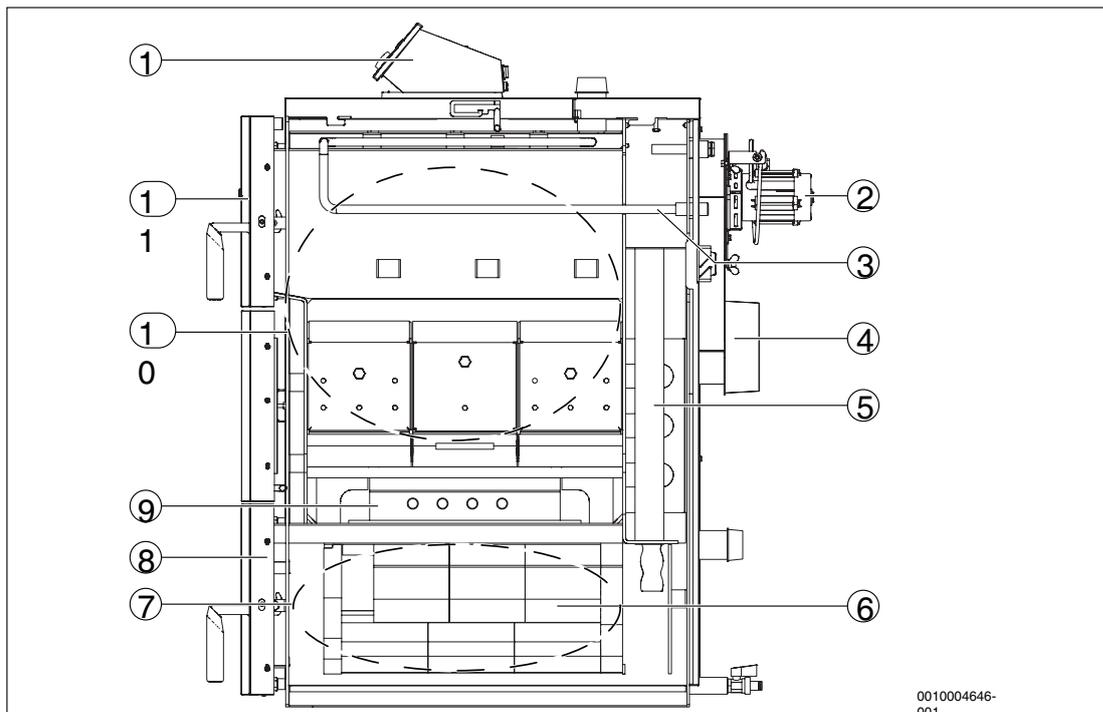
Рис. 1 Функциональные элементы котла
