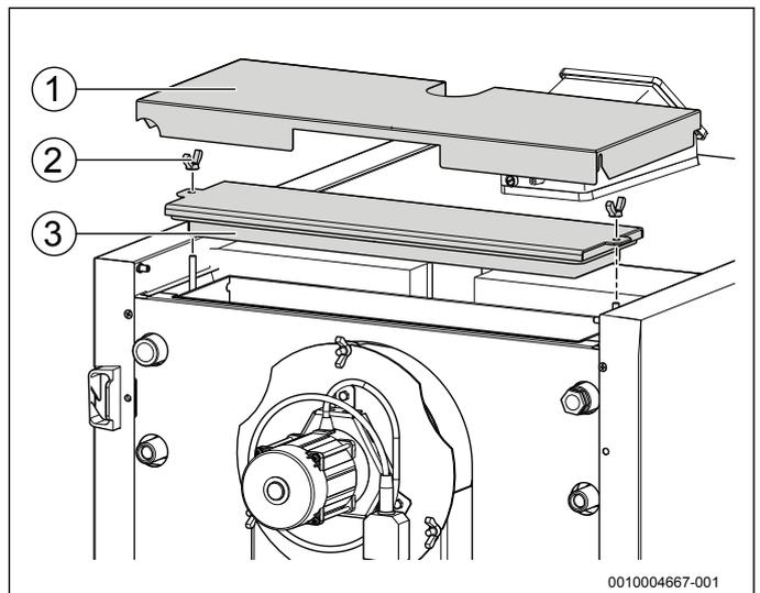
Рис. 13 Смотровые люки в коллекторе дымовых газов
