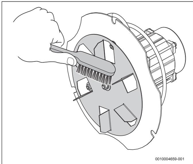
Рис. 17 Чистка крыльчатки вентилятора
