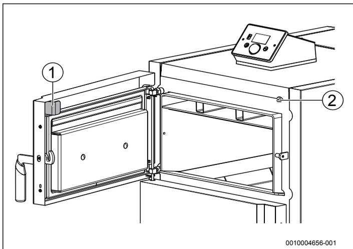
Рис. 5 Дверной выключатель [1] Винт дверного контакта [2] Дверной выключатель
