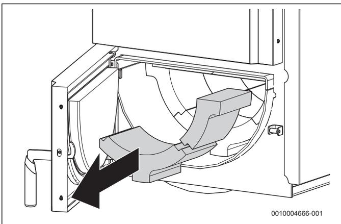
Рис. 15 Выемка шамотных камней
