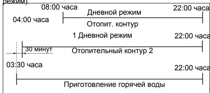
Рис. 10 Пример: приготовление горячей воды
