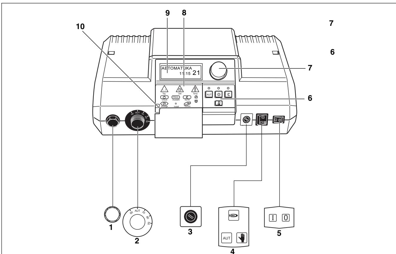
Рис. 4 Элементы управления Logematic 2107 и Logematic 2107 M
