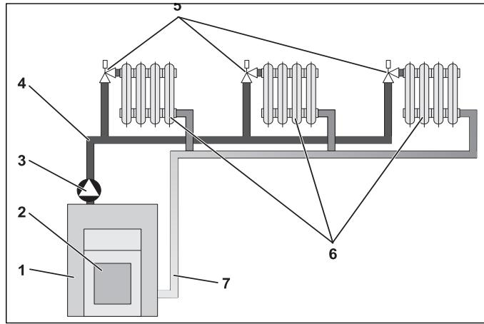
Рис. 1 Схема системы отопления с насосом
