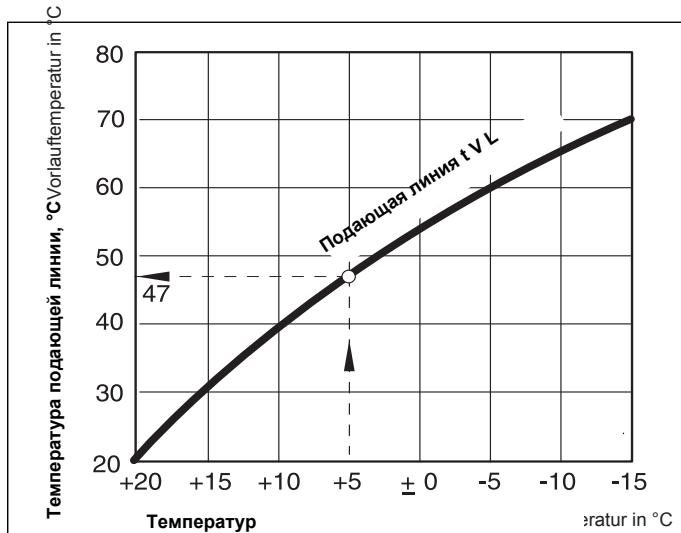
Рис. 3 Графическая характеристика отопительного контура (пример)
