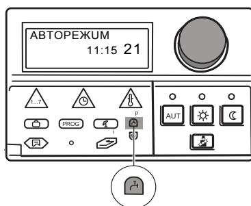
С помощью системы управления Logamatic 2107 можно экономично нагревать воду для контура горячего водоснабжения. Для этого предусмотрено приготовление горячей воды по таймеру. Вы можете включить приготовление горячей воды, установив нужную температуру. Для экономии энергии приготовление воды вне запрограммированных временных интервалов отсутствует.
