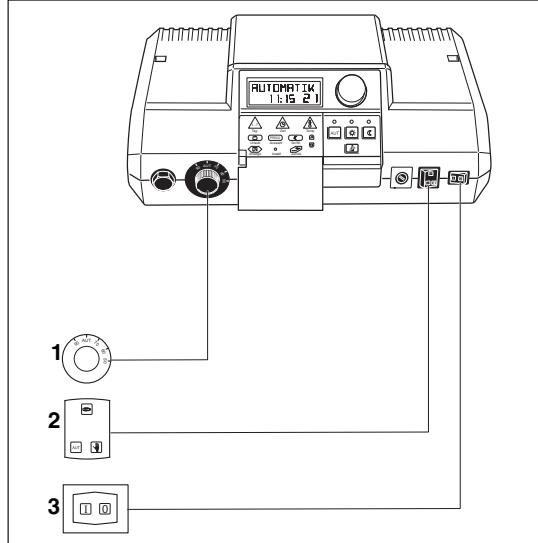
возможные запросы. Котел при выключенных насосах доводится как можно быстрее до необходимой для замеров температуры подающей линии (индикация текущей температуры котловой воды на дисплее) и производится попытка удерживать эту температуру через подключаемого потребителя без выключения горелки. Таким образом выдерживается максимальный период времени для проведения замеров дымовых газов.
