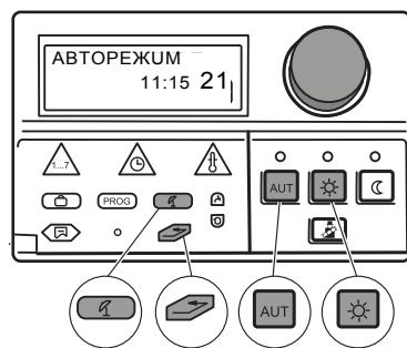
В системе управления Logamatic 2107 переключение с летнего режима на зимний и наоборот происходит с некоторым запаздыванием по времени, так как сигнал от датчика наружной температуры поступает уже с учетом аккумулирующей способности здания и его теплоизоляции (в дальнейшем она будет называться "демпфирированной наружной температурой").
