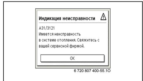
Рис. 6 Индикация неисправности
