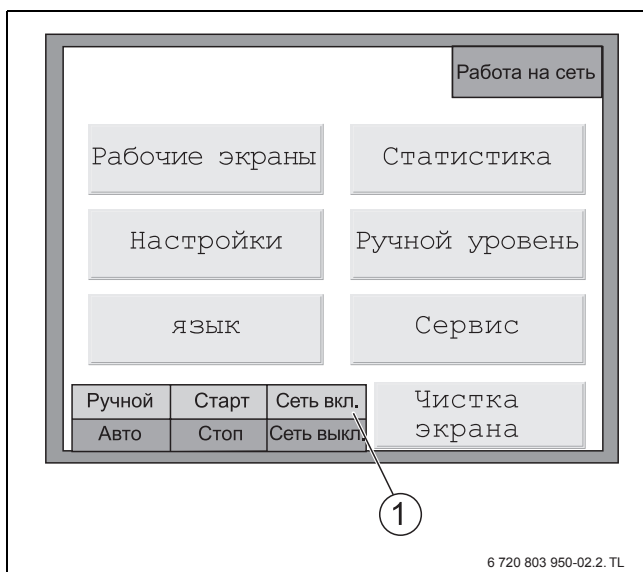
Рис. 8 Включение силового реле генератора
