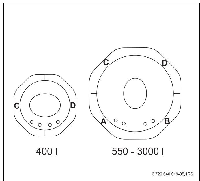
Рис. 8 Маркировка частей теплоизоляции
