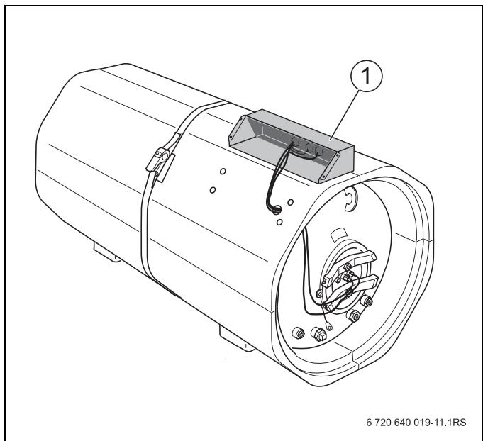
Рис. 14 Установка системы управления
