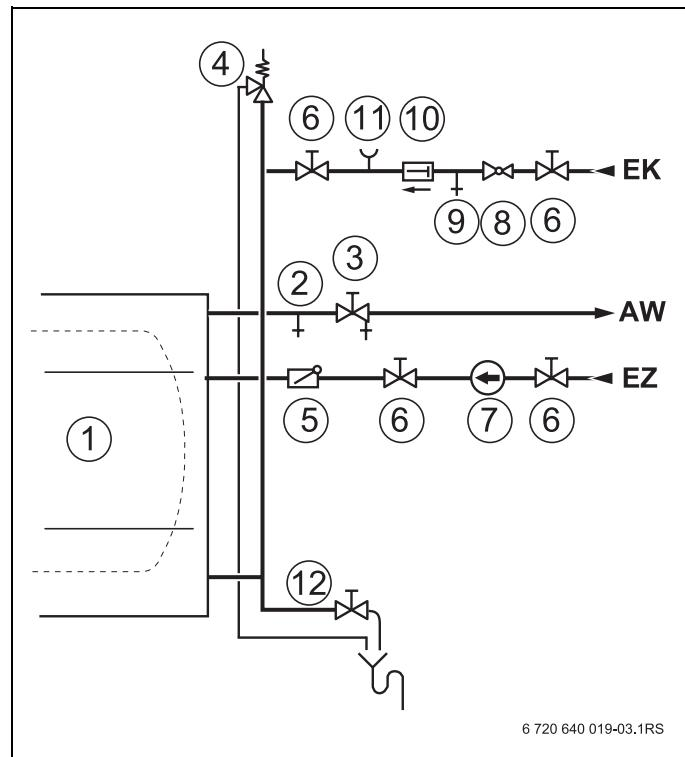
Рис. 6 Гидравлическая схема подключения бака
