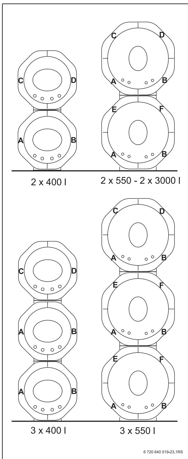
*Рис. 26 Маркировка теплоизоляционных сегментов сдвоенных и тройных баков*
