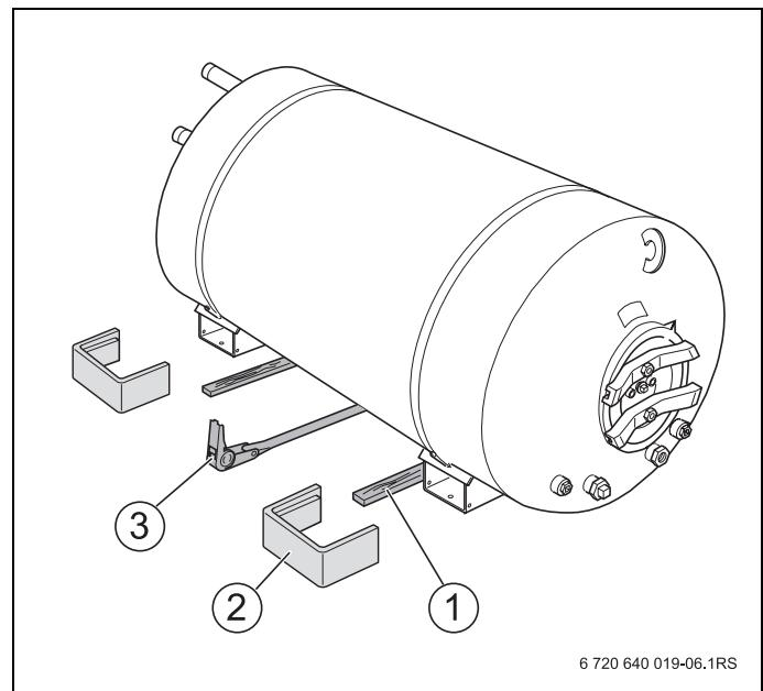
Рис. 9 Подготовка монтажа теплоизоляции
