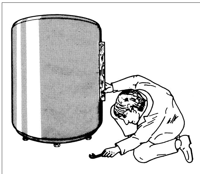
Рис. 5 Регулировка опорных болтов
