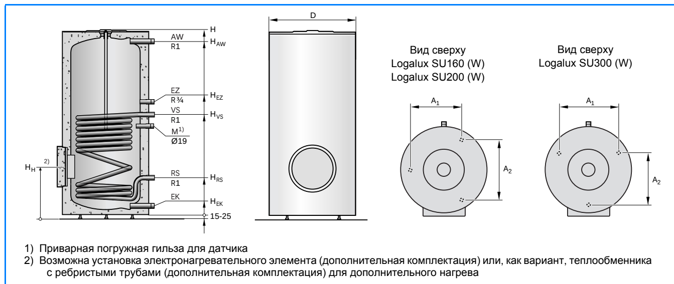
94/1 Размеры вертикальных баков-водонагревателей Logalux SU160 (W) - SU300 (W)
